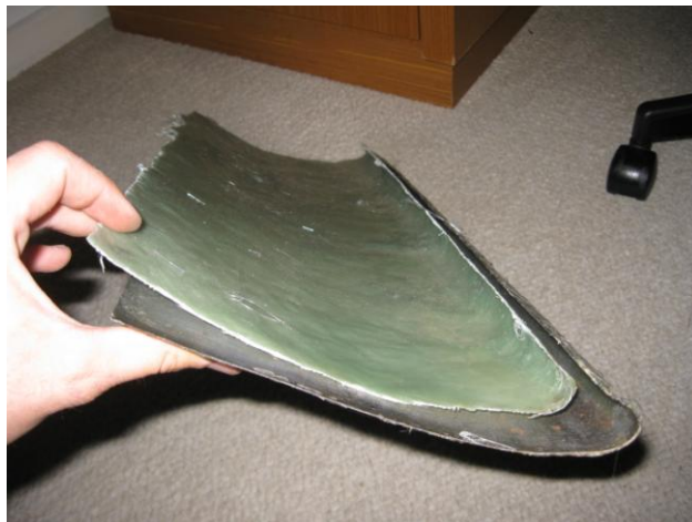
Figura 42: Gabarito (chapa de aço) e o laminado (meio perfil do fólho)
