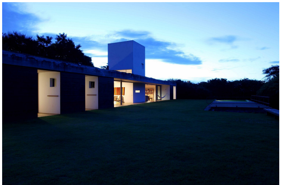
Fechamento dos quartos se dá por meio de portas de correr de madeira que ao serem abertas se tornam parte da fachada da casa.
