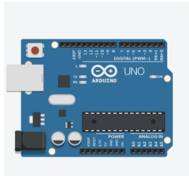
Figura 6 – Arduino UNO R3
