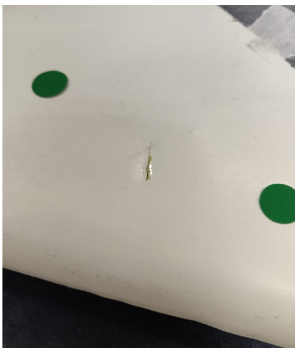
Figura 12: Corpo de prova com o dano (trinca) facilmente detectável a olho nu.
