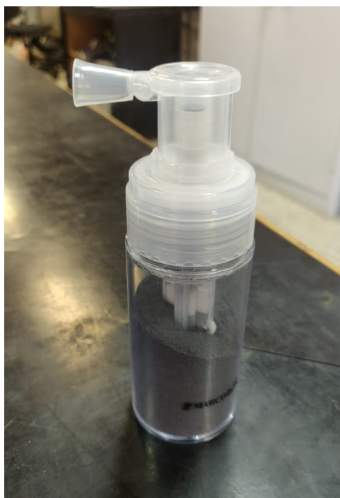
Figura 13: Pulverizador de talco com alumina preta utilizado para aplicação do mosqueado.
