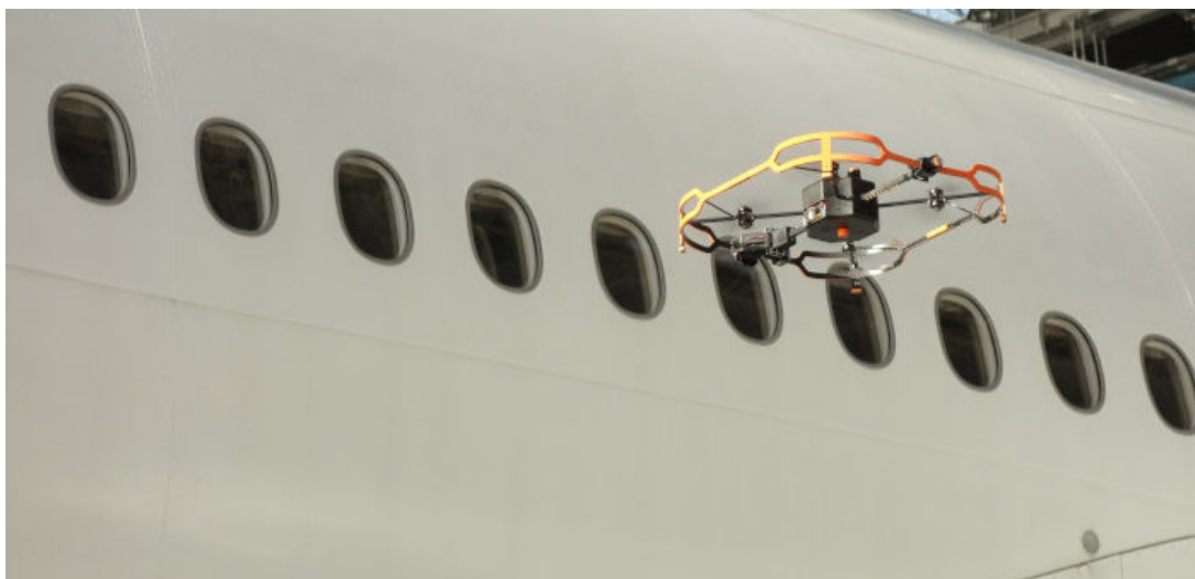
Figura 3: Drone utilizado para inspeção visual de estruturas aeronáuticas – detecção de danos de até 1 mm (Sampson, 2019);
