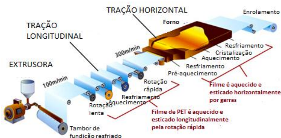
Figura 3 - Esquemática do processo de fabricação de películas de BoPET (Johnson Window Films) - Traduzido
