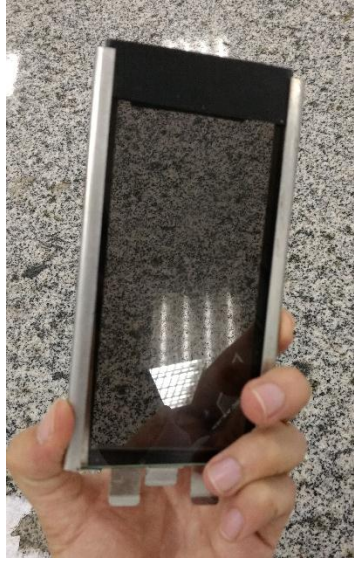
Figura 7 - Película aplicada sobre vidro para teste no equipamento Weather O'Meter.
