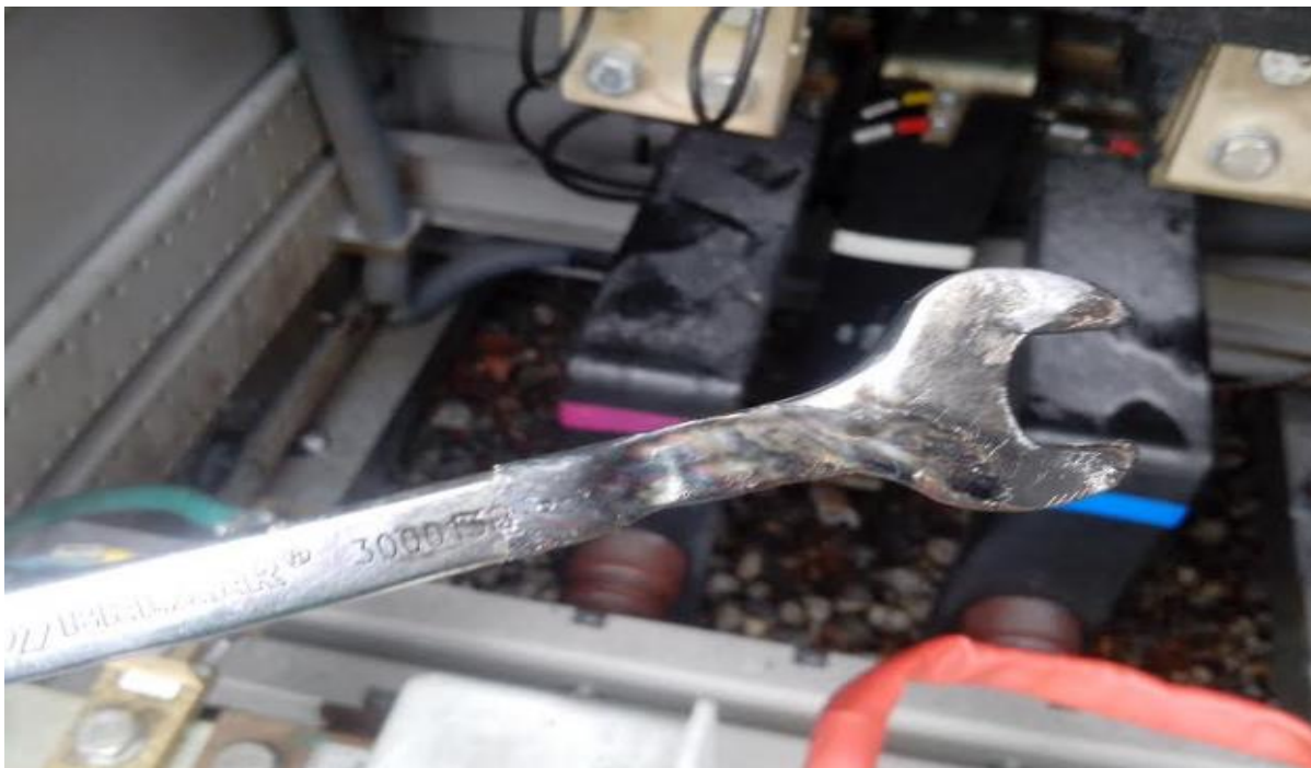
Figura 25: Ferramenta utilizada pelo colaborador: chave de boca
