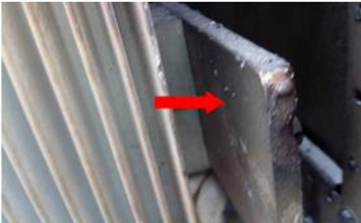
Figura 27: Barramento com parte estilhaçada após efeito do arco elétrico
