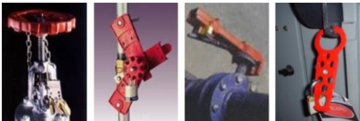
Figura 18: Aplicação do Sistema Loto - bloqueio
