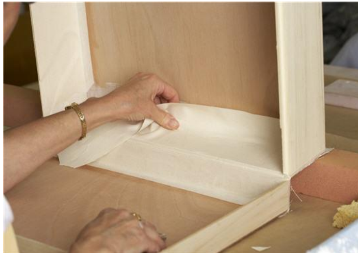
Figura 6 - Colagem da "charnière".
