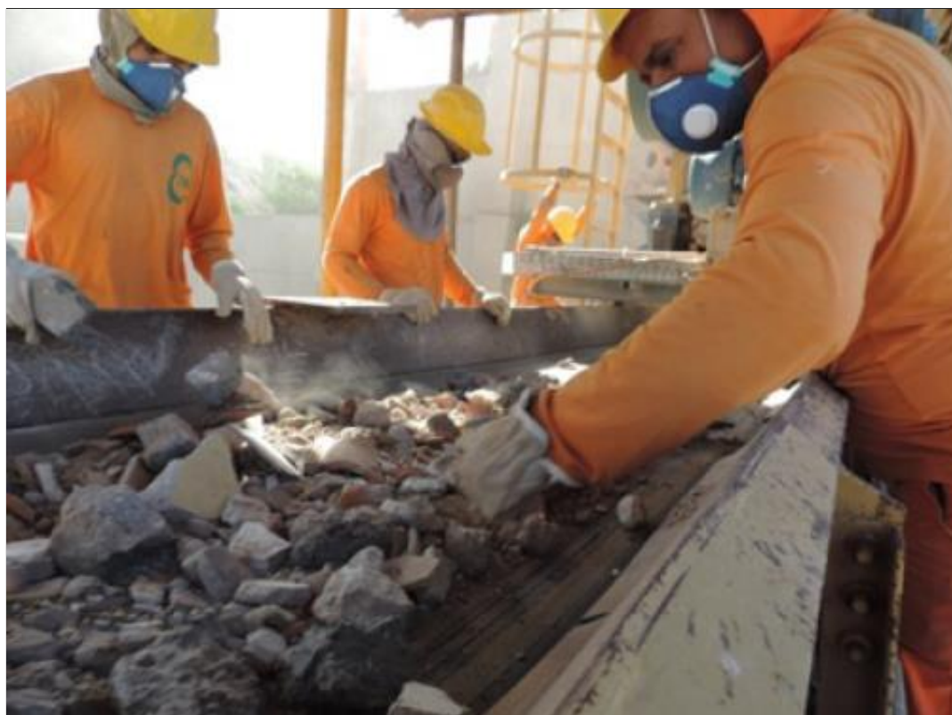
Figura 15 - Segunda triagem realizada durante o processo
