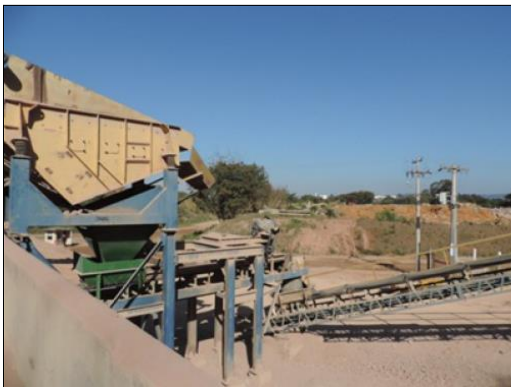
Figura 16 - Peneiramento granulométrico dos materiais
