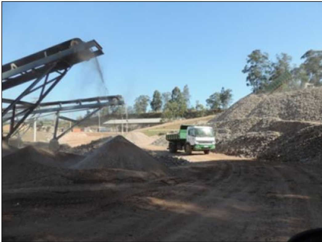
Figura 13 - Transporte dos resíduos triados para o processo de britagem
