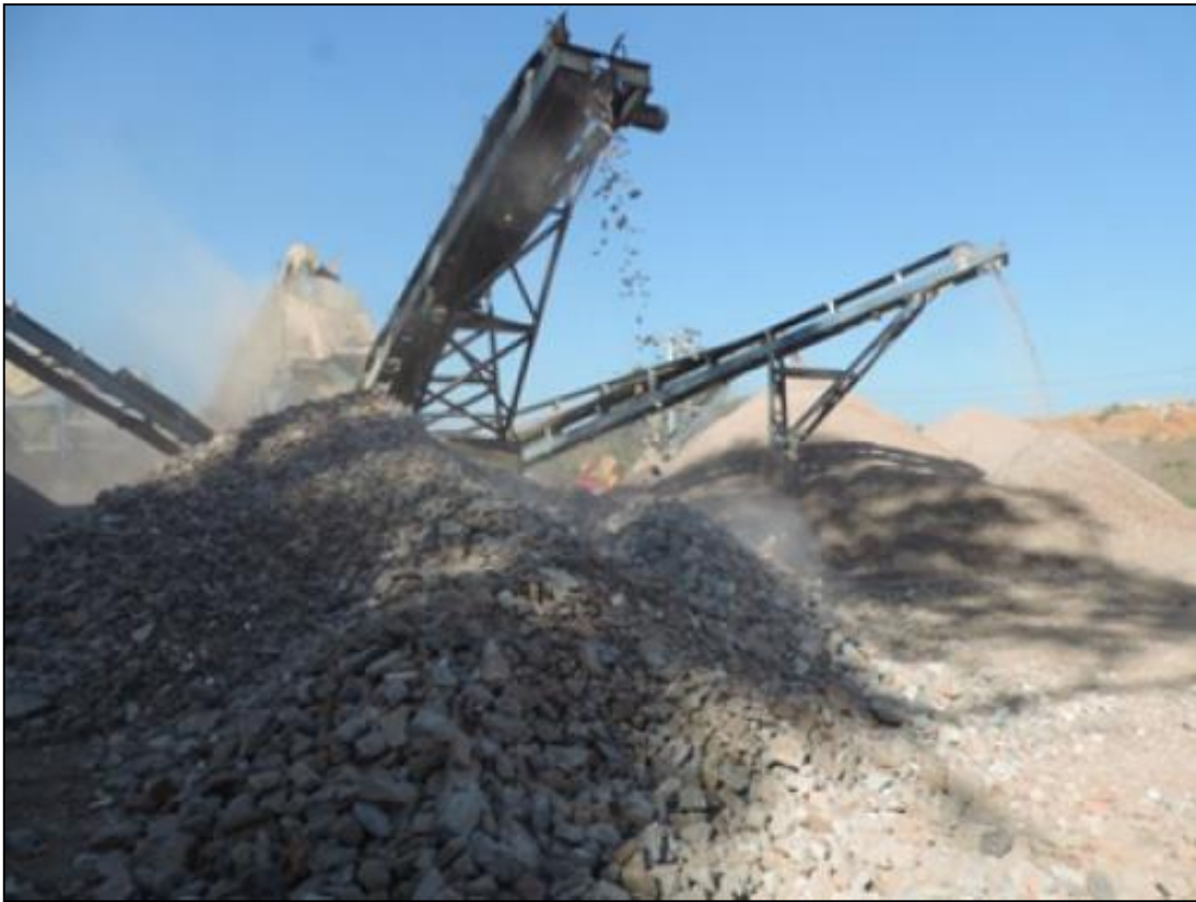
Figura 17 - Deposição do material conhecido por Brita 3
