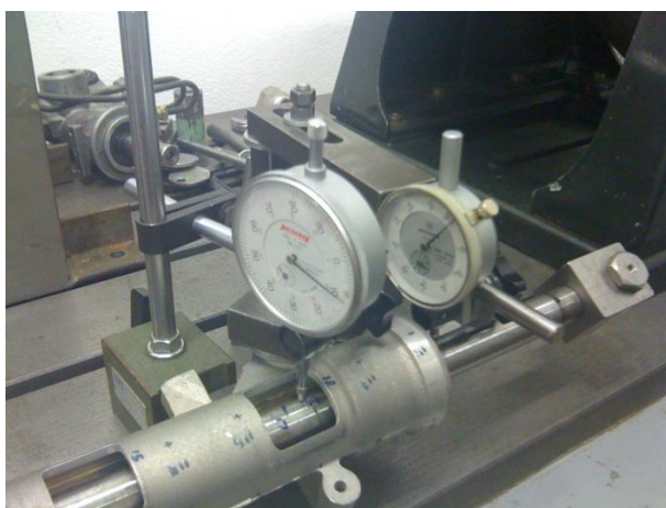
Figura 7 - Montagem dos relógios comparadores
