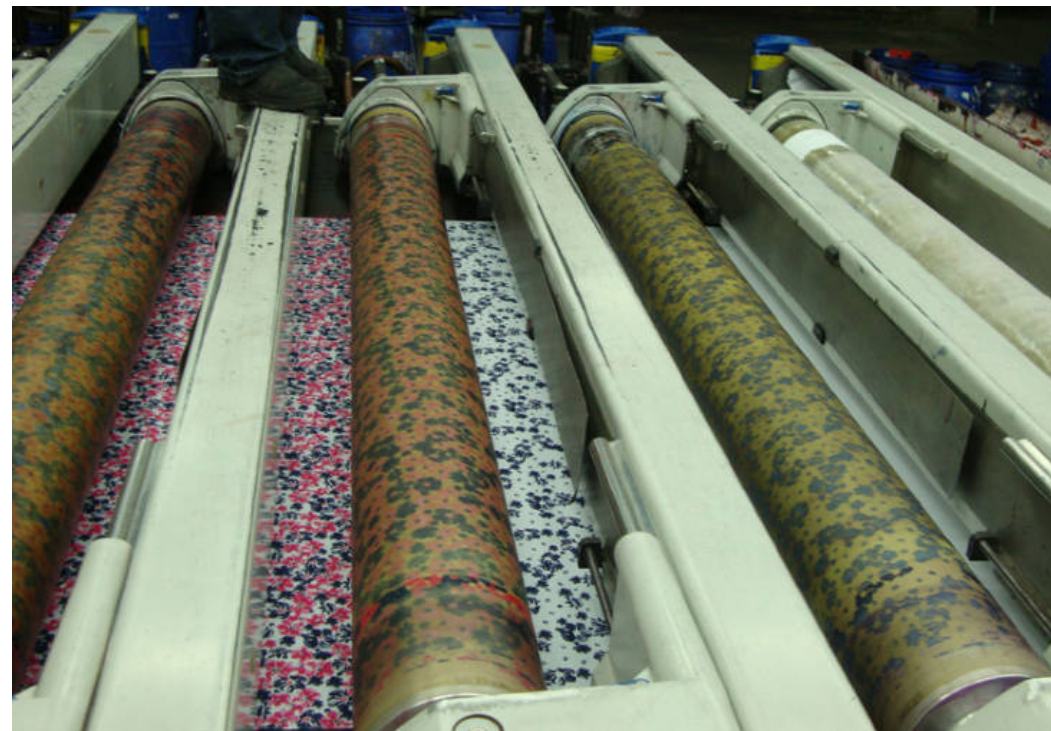
Figura 4: Máquina de estampar com cilindros. Fonte: Pesquisa Google.
