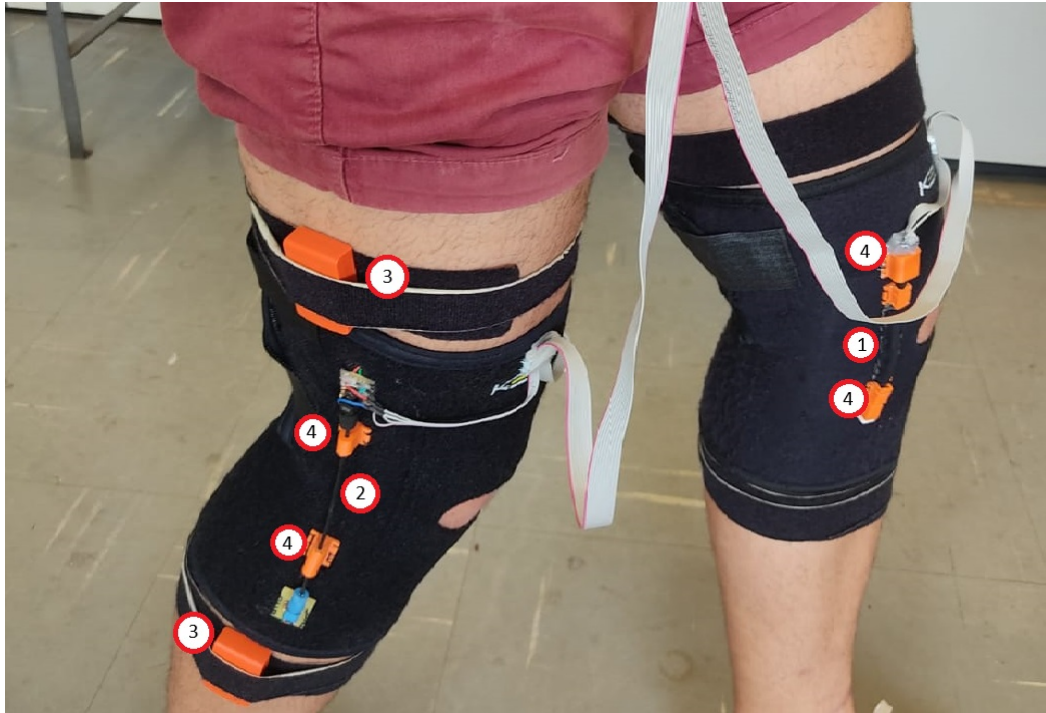
Figura 10 – Montagem experimental do sistema vestível 1. Sensor Capacitivo. 2. Fibra ótica. 3. Xsens. 4. peças em 3D.
