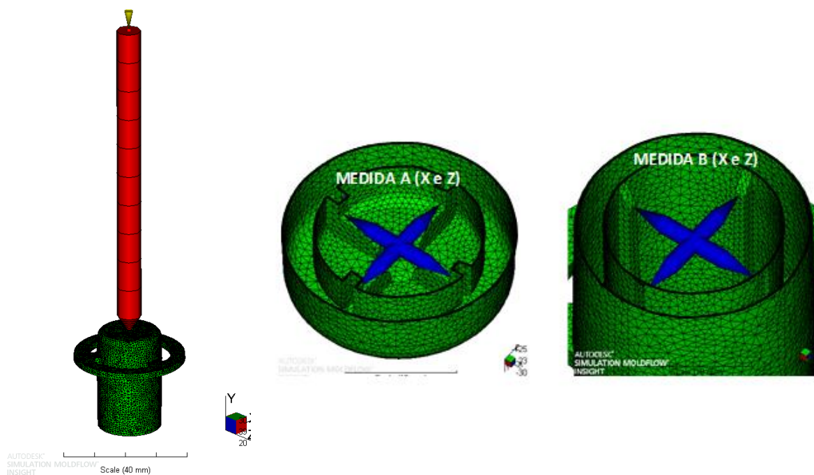
Figura 22: Cotas a serem analisadas para o sifão: dimensões das travas no interior do sifão que garantem seu correto encaixe. Medida A apresenta cota HIC 12,32 +- 0,15 mm. Medida B: cota HIC 13,2+- 0,2mm
