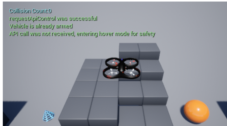
Figura 8 – Drone de base voando em um ambiente de simulação com o modelo Blocks , padrão do Airsim .
