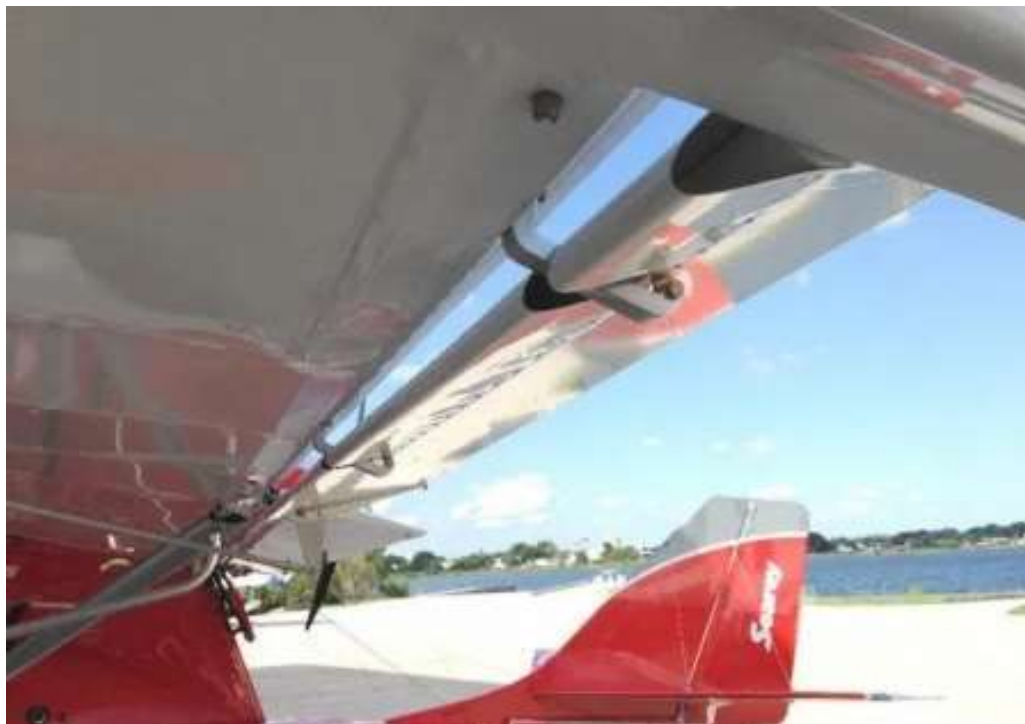
Figura 8 – Arquitetura típica de um Frise-type aileron (IVAO, 2021).
