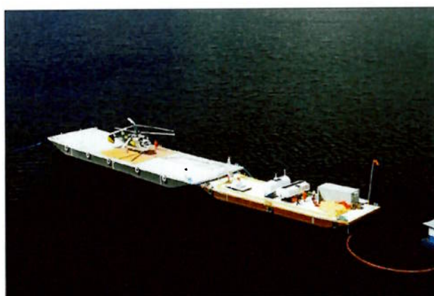
Ilustração 3. Ponto de reabastecimento que foi adaptado a partir de balsas sobre rio, para abastecimento com motores e/ou rotores girando. Cortesia de Jeane Ramos e Jean Luis.
