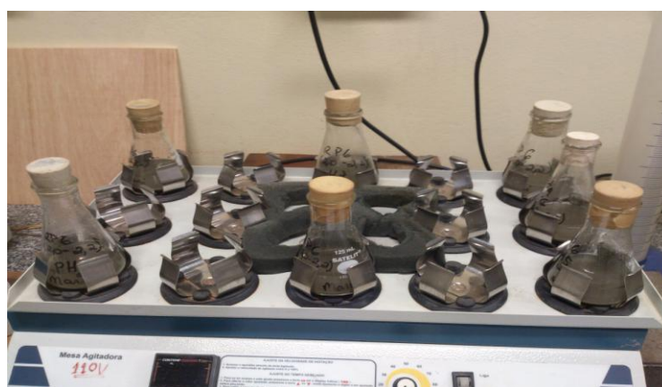
Figura 7 - Mesa agitadora contendo as amostras utilizadas no ensaio de variação de pH.
