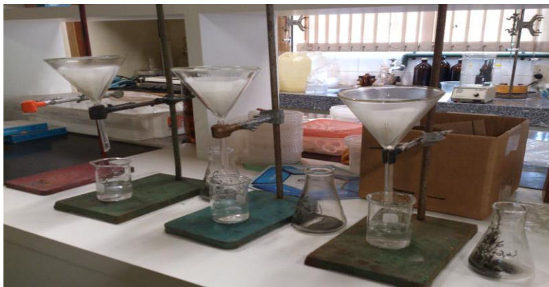
Figura 8 – Filtragem das amostras após 24 horas de agitação – ensaio de variação de pH.
