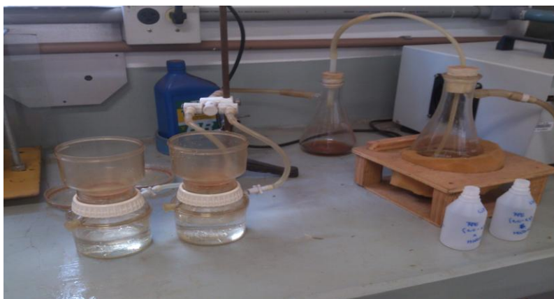
Figura 6 - Filtro a vácuo utilizado para obtenção do filtrado – ensaio de lixiviação.
