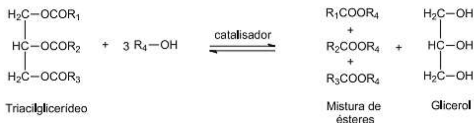
Figura 2: Esquema simplificado da reação de transesterificação (GERIS et al., 2007)
