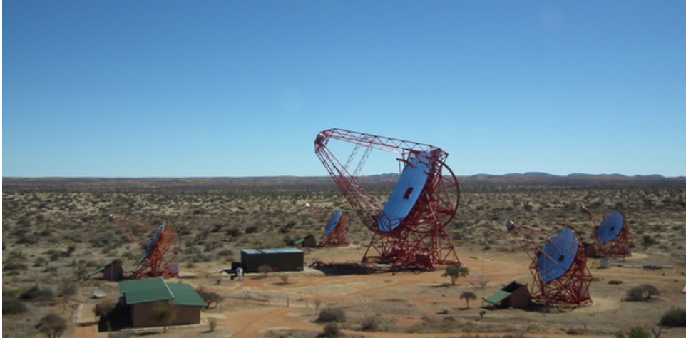
Figura 3 – Vista do Observatório H.E.S.S. (High Energy Stereoscopic System) no deserto da Namíbia. Na imagem, destacam-se os cinco telescópios Cherenkov, sendo quatro com espelhos de 12 metros de diâmetro e um maior, no centro, com um espelho de 28 metros. Fonte: H.E.S.S..
