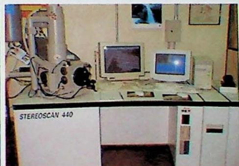
Foto 9 – Microscópio eletrônico de varredura.
