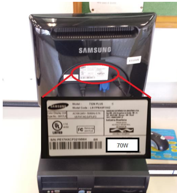
Figura 20 – Modelo de computador e monitor utilizado pelos funcionários do edifício e utilizado como base para levantamento
