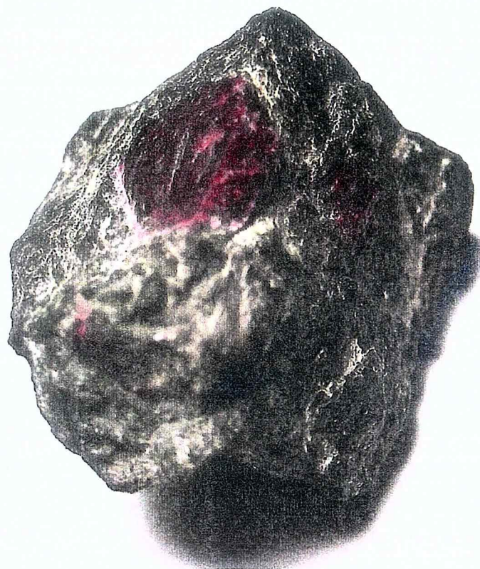
ANEXO 5 : Rocha ( Turmalina-Clorita-Corindon-Xisto) com porfiroblastos de Rubi. O tamanho da amostra e 5 cm.
