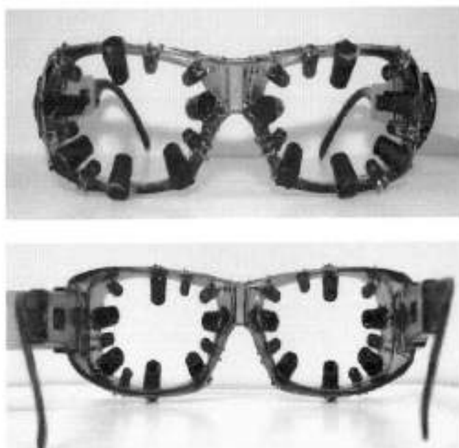
Figura 12 - Óculos com sensores e LEDs utilizado para rastreamento [20]
