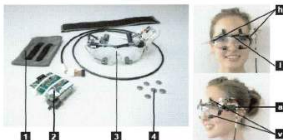
Figura 9 - Componentes do sistema de eye tracking: (1) bracelete com uma bolsa, (2) microprocessador, (3) óculos, (4) eletrodos, (h) e (v) eletrodos verticais e horizontais respectivamente, (l) sensor de luz e (a) acelerômetro. [3]
