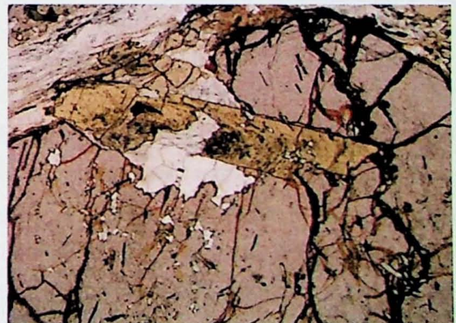
Foto. 36 (Car-IX-26). Grande porfiroblasto de estaurolita prismática se desenvolvendo substituindo porfiroblastos de granada no metamorfismo progressivo. (Lado maior 3,25mm)
