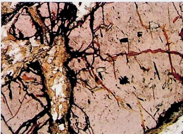
Foto. 35 (Car-IX-26). Observam-se inclusões de cloritóide nos porfiroblastos de granada pré- S2; notar que eles também estão presentes na fratura associados à clorita, substituindo a granada no retrometamorfismo pós-cinemático. (Lado maior 3,25mm)
