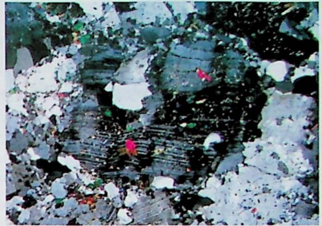
Foto. 10 (Car-I-12). Porfiroclasto de plagioclásio com inclusões de zoizita; geminação polissintética deformada (kink); contato lobado entre os cristais de feldspato (Lado maior 3,25mm).
