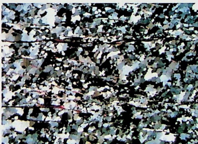
Foto. 1 (Car-VI-27b). Quartzito com lentes lepidoblásticas de muscovita e contato sub-polygonizado entre os cristais de quartzo que compõem a matriz granoblástica. Notar o aspecto anastomosado da foliação. (Lado maior 6,5mm)
