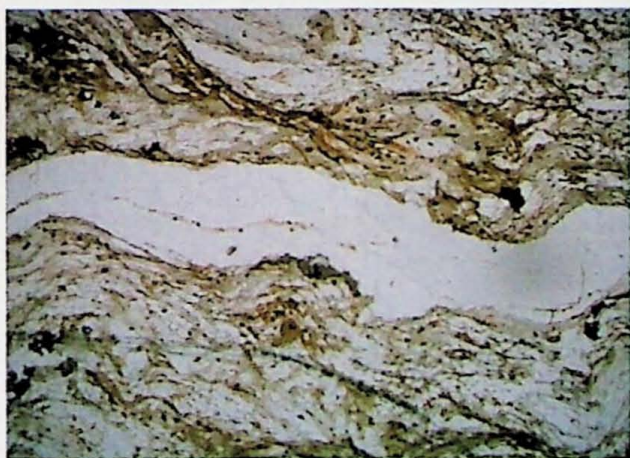
Foto. 7 (Car-I-14). Aspecto geral do biotita xisto com lente granoblástica de quartzo ondulada. (Lado maior 3,25mm)
