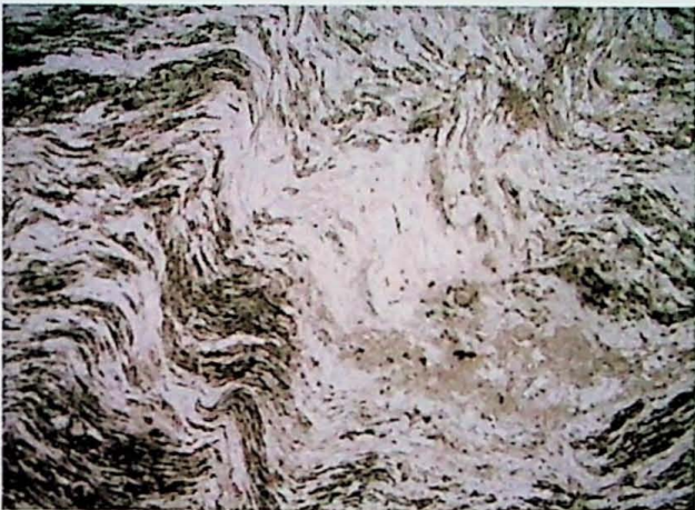
Foto. 5 (Car-I-48A). Aspecto geral do cloritóide- muscovita xisto crenulado com ênfase nas bandas de textura nematoblástica compostas de cloritóides prismáticos finos sin-S2 crenuladas. (Lado maior 3,25mm)
