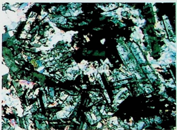
Foto. 40 (Car-VI-3). Grandes porfiroblastos de cloritóide pós-cinemáticos substituindo porfiroblastos de estaurolita granada (Lado maior 3,25mm).
