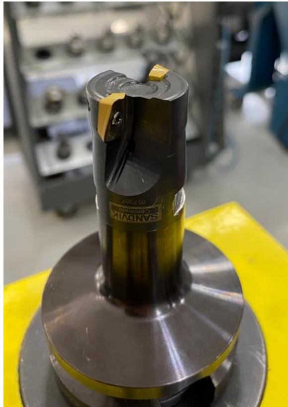
Figura 14 - Fresa utilizada os insertos já montados (D=25mm)
