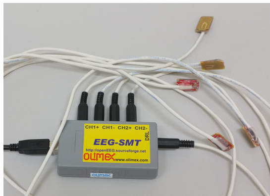
(b) Kit Olimex OpenEEG pronto para ser usado
