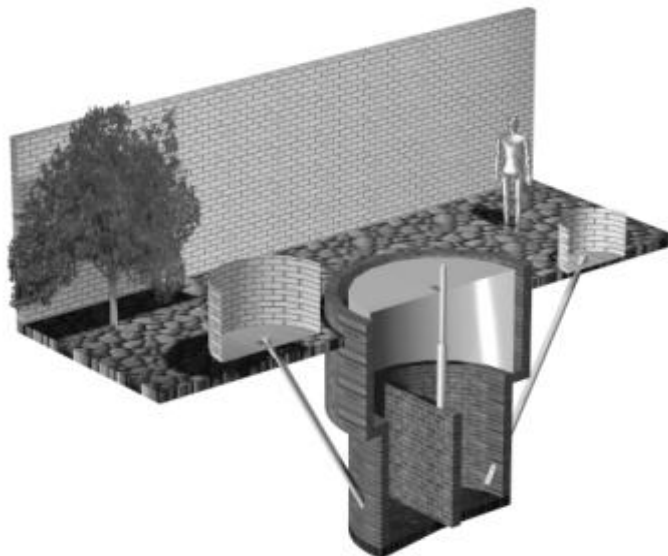
Figura 2 – Representação tridimensional em corte do biodigestor tipo Indiano [21].
