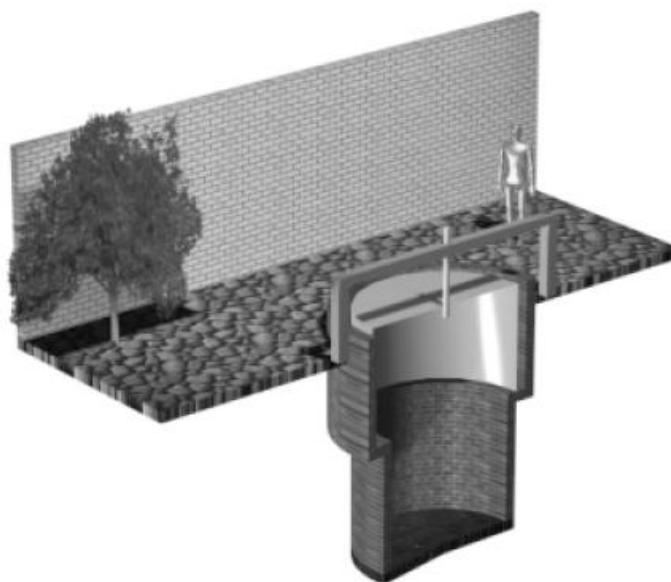
Figura 9 – Representação tridimensional em corte do biodigestor tipo Batelada [21].
