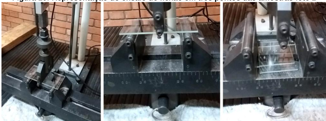
Figura 10: Representação do ensaio de flexão em três pontos das amostras lote B
