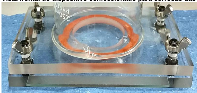
Figura 8: Vista frontal do dispositivo confeccionado para corrosão das amostras
