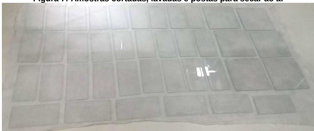
Figura 7: Amostras cortadas, lavadas e postas para secar ao ar
