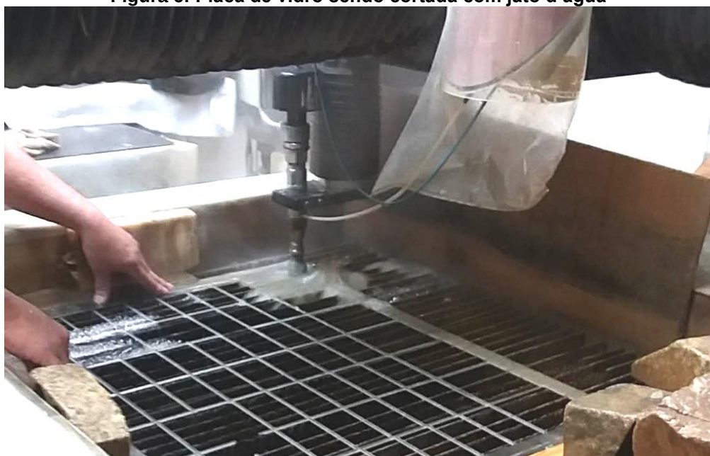
Figura 6: Placa de vidro sendo cortada com jato d'água
