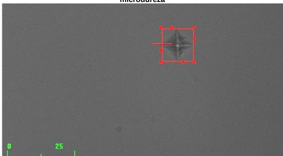
Figura 11: Indentação em amostra irradiada com laser na combinação ideal durante ensaio de microdureza
