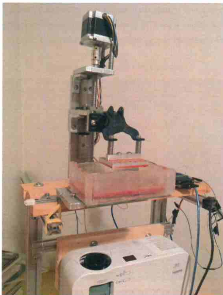
Figura 97 - Protótipo de impressora estereolitográfica DLP usada
