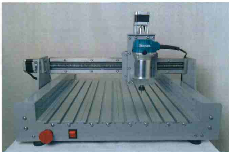
Figura 46 - Fresadora Router CNC Etruska EK01
