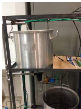
(c) Válvulas da fervura e do mosto e bomba da fervura
