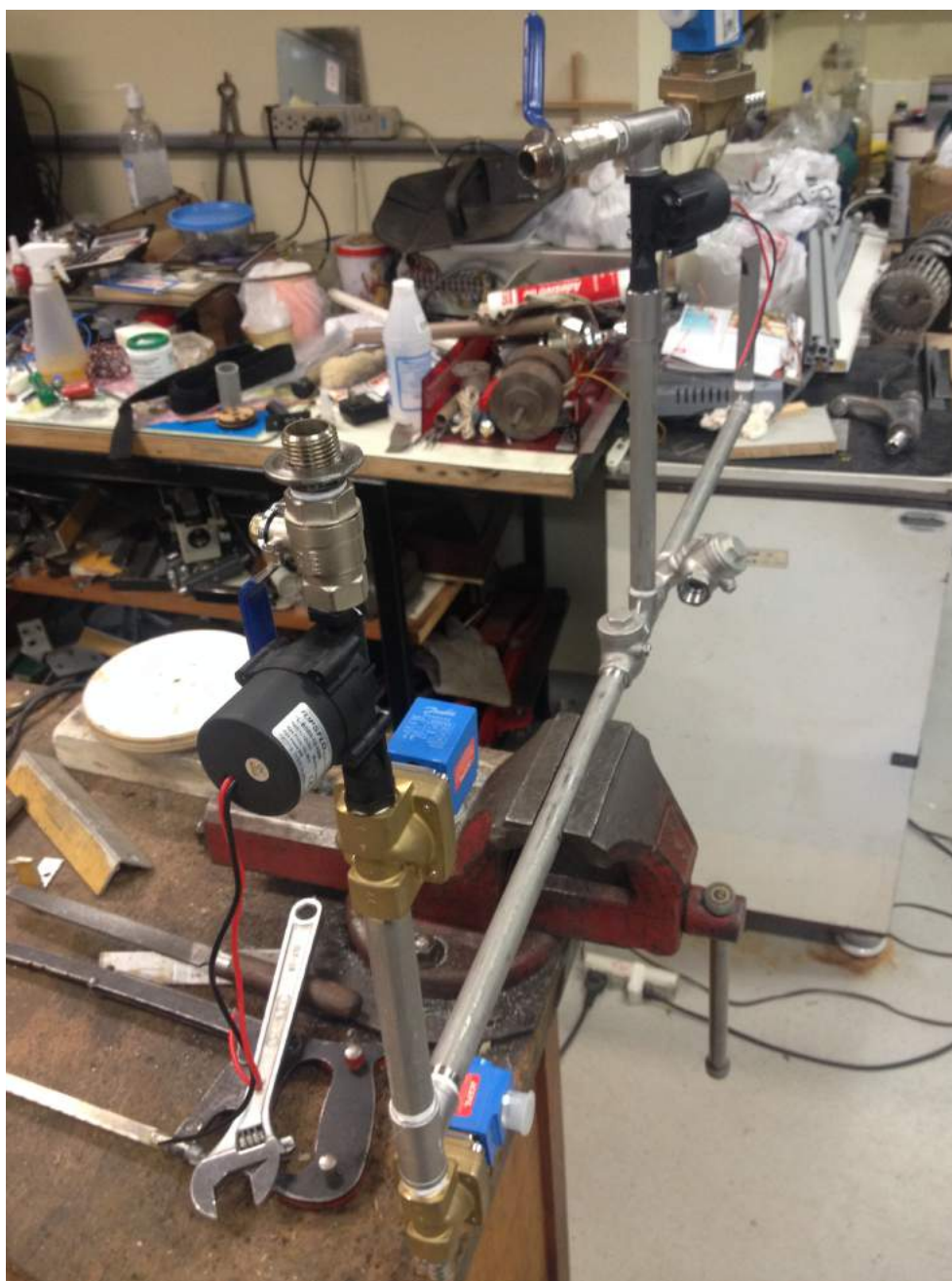
Figura 5.56: Processo de rosqueamento e vedação da tubulação e elementos relacionados
