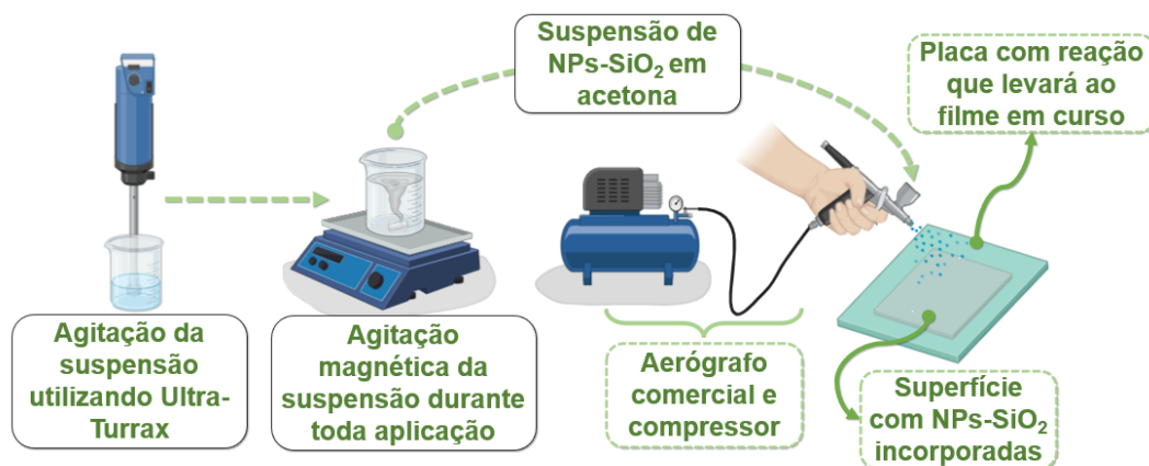
Figura 9. Esquema representativo da aplicação das NPs-SiO 2 nos filmes utilizando aerógrafo.
