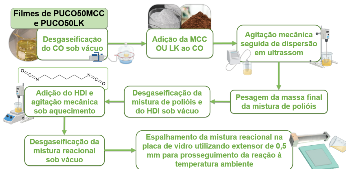
Figura 7. Esquema representativo para a síntese dos filmes PUCO50MCC e PUCO50LK
