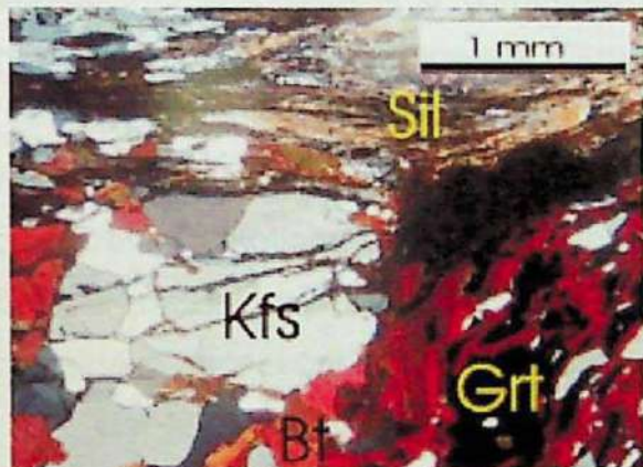
Fotomicrografia 3: Paragênese Bt+Grt+Sil+Kfs em rocha Polarizadores cruzados. Lâmina OL-VIII-31B. Ponto:952.
