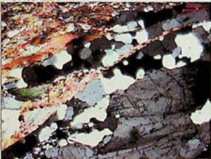
Fotomicrografia 17: Plagioclásio com geminação lei da albita encurvada, biotita encurvada e quartzo em ribbons . Polarizadores cruzados. Lâmina SB-VII-149. Ponto 2201.
