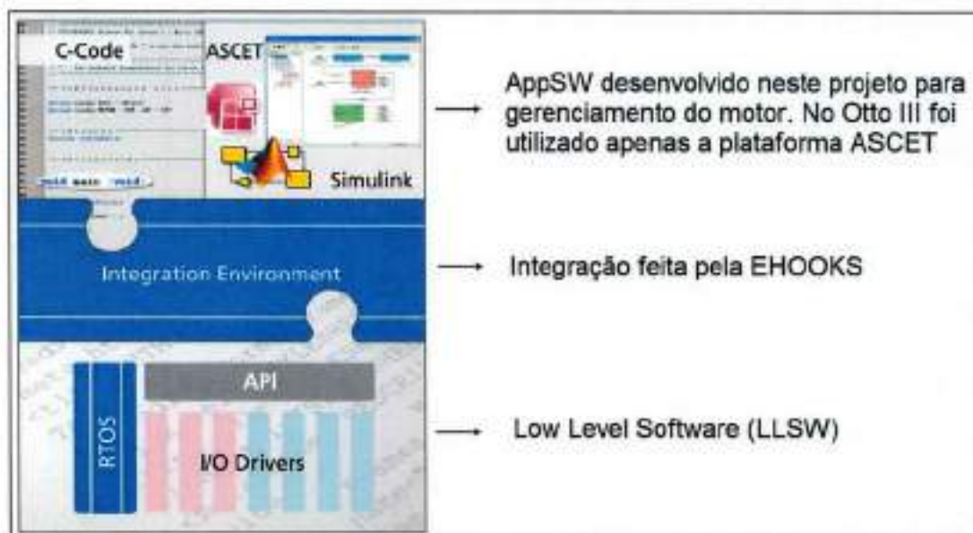
Figura 13 – Arquitetura de SW da FlexECU
