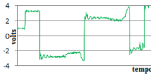
Sinal de um segmento com falta de terminadores
