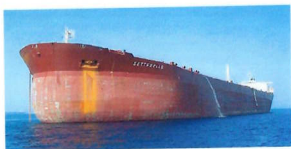
Foto 2 – Very Large Crude Carrier - VLCC – SETEBELLO. Dimensões: 346 metros de comprimento, 58 metros de largura e 73 metros de altura. Navio selecionado para se transformar em plataforma de exploração de petróleo.
