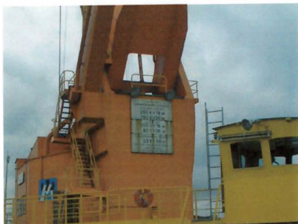
Foto 69 – Placas indicativas da capacidade máxima de içamento do guindaste em função do raio da lança. As operações de movimentação de carga apresentam alto risco de acidentes e demandam intensa análise de perigos e riscos, estudo e planejamento.
