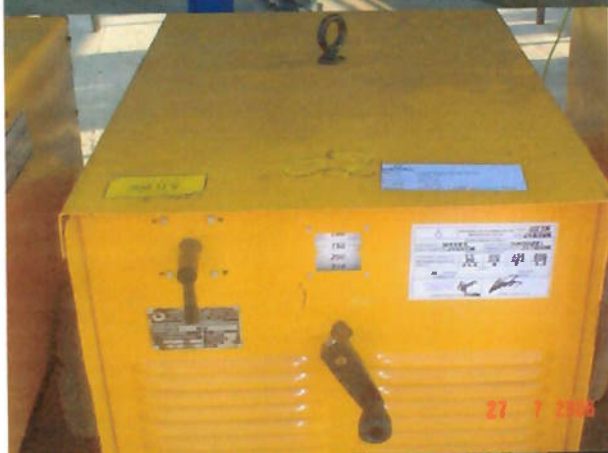
Fotos 31 e 32 – Máquinas de Solda contendo as etiquetas atestando as inspeções de segurança e liberação para uso do equipamento.
