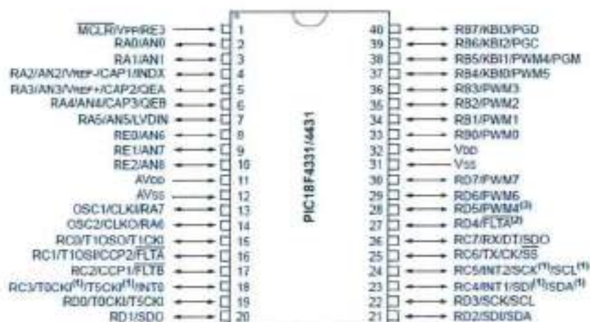
Figura 9 – Diagrama de pinagem(PIC 18F4331)
