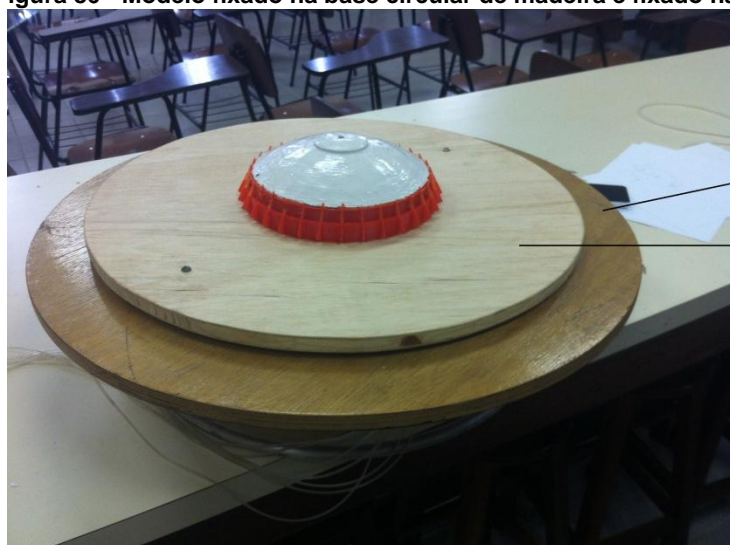
Figura 86 - Modelo fixado na base circular de madeira e fixado na base metálica do túnel
