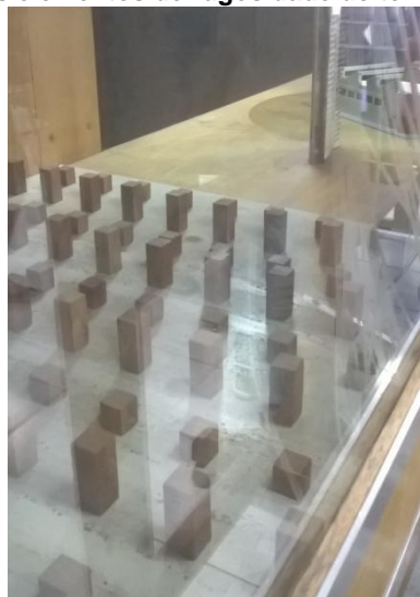
Figura 113 – Foto dos elementos de rugosidade do terreno do túnel de vento
