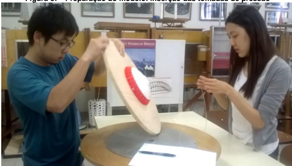
Figura 87 - Preparação do modelo: inserção das tomadas de pressão
