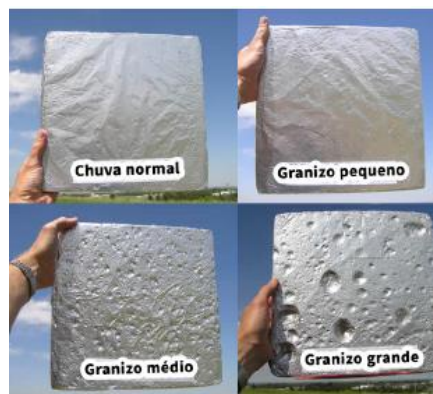
Figura 30 - Sequência de imagens com diferentes hailpads
