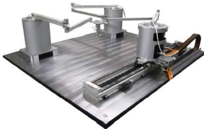
Figura 3 Manipulador planar (P)RRR+2RRR construído pelo Instituto de Sistemas Mecatrônicas na Universidade de Leibniz em Hanover na Alemanha
