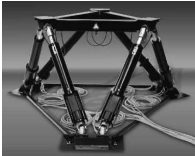
Figura 5: O robô hexápode, plataforma de Stewart, que, quando estático, tem links agindo como elementos de treliça.
