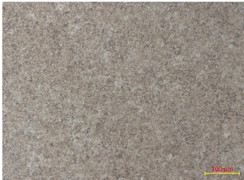
Figura 5-1: Microestrutura resultante do processo de revenimento único por 6h a 250°C. Presença de martensita revenida. Aumento de 100X.
