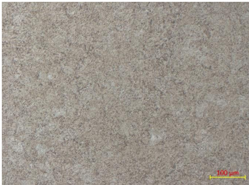
Figura 5-3: Microestrutura resultante do processo de duplo revenimento por 2h a 250°C. Presença de martensita revenida. Aumento de 100X.
