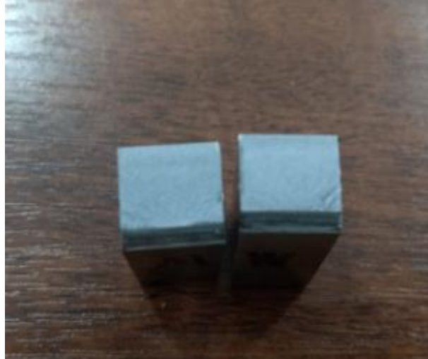
Figura 5-7 – Aspecto da fratura após ensaio Charpy, representativo de todas as condições de ensaio.
