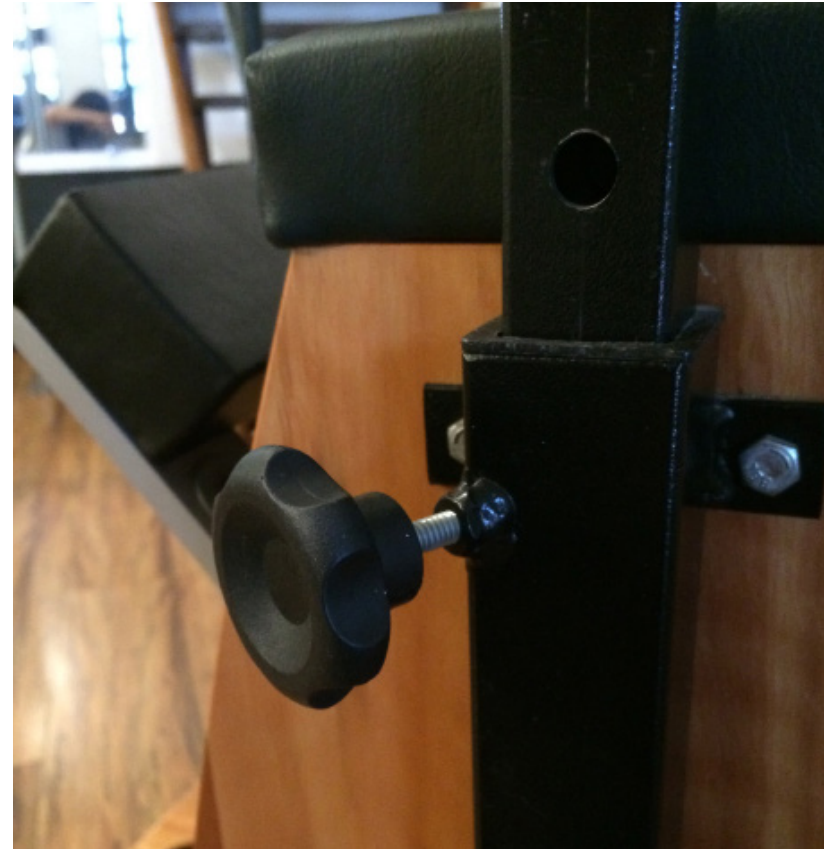
Figura 5- Chair: detalhe de rosca exposta
