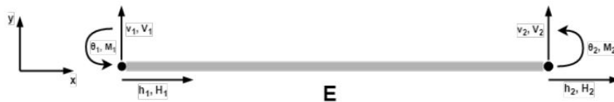
Figura 8 Um elemento com três GDL por nó e as forças exercidas em cada nó
