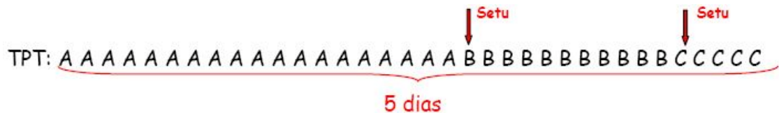
Figura 8 - Exemplo do TPT em um sistema desnivelado
