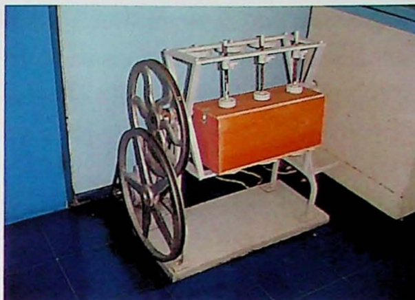
Figura 4 – Caixa de madeira acoplada a agitador elétrico.
