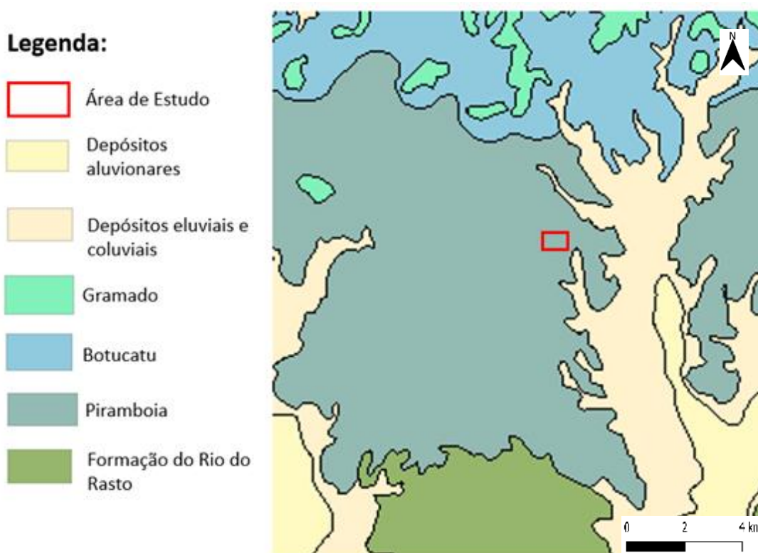
Figura 4 - Litoestratigrafia 1:1.000.000, com destaque para a localização aproximada da Área de Estudo inteiramente na Formação Piramboia.
