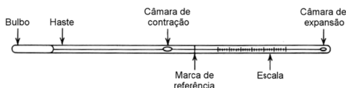
Figura 3 – Principais características de um termômetro de mercúrio. Fonte: BENEDICT (1984).
