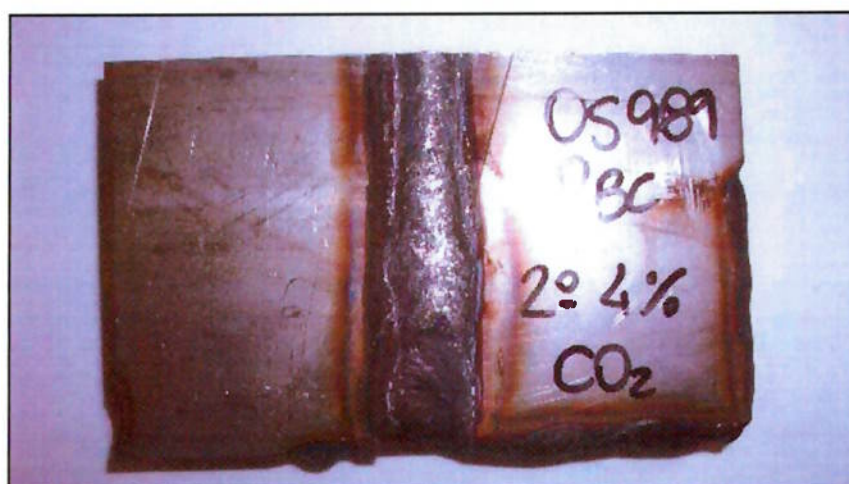
Figura 4.4 – Amostra retirada do corpo de prova para ensaio metalográfico.
