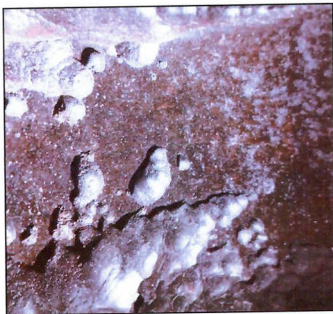
Figura 2.4 – Corrosão naftênica em tubo de forno atmosférico, material aço liga 5%Cr ½Mo.
