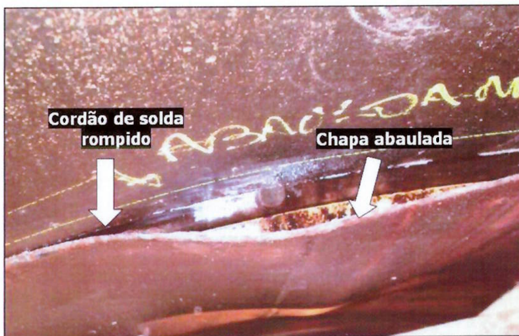
Figura 2.13 – Chapas de lining sobrepostas com rompimento na solda e abaulamento devido à penetração de produto.
