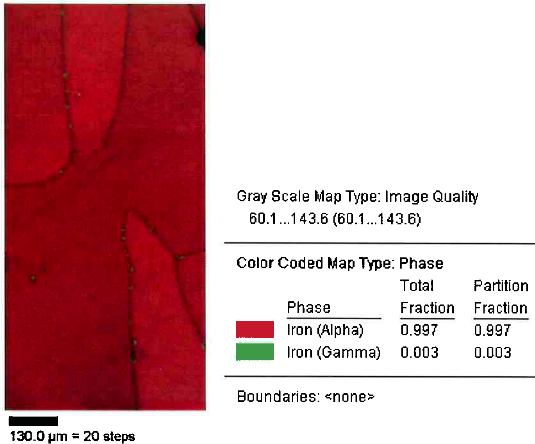
Figura 47 - Mapa de quantificação das fases, amostra solubilizada a 1050°C.
