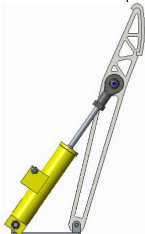
Figura 5: Montagem do cilindro mestre e pedal de freio
