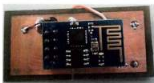
Figura 17 – Placa de alimentação do módulo wifi: vista superior
