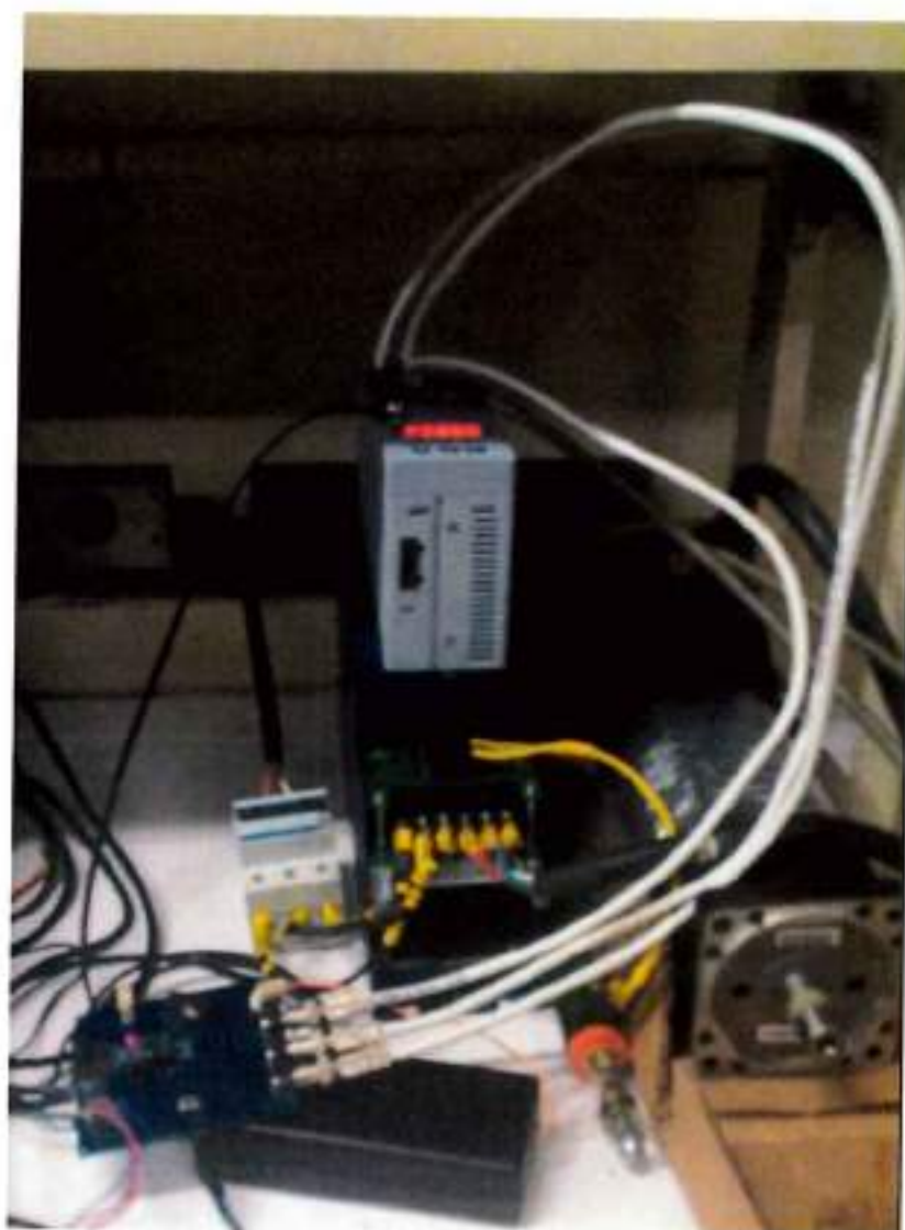
Figura 24 – Servomotor conectado à placa controladora
