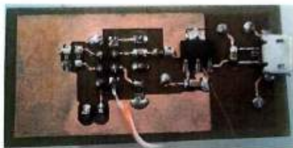
Figura 16 – Placa de alimentação do módulo wifi: vista inferior
