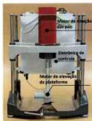
Figura 1 – Reômetro tipicamente utilizado em ensaios reométricos
