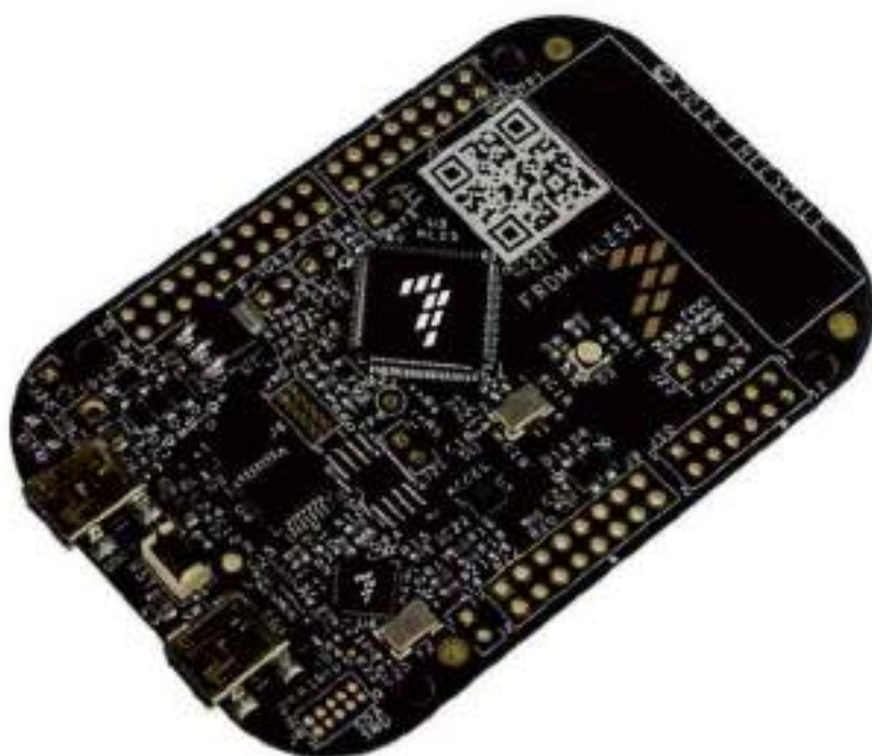
Figura 15 – FRDM-KL25Z: placa de desenvolvimento do KL25Z128
