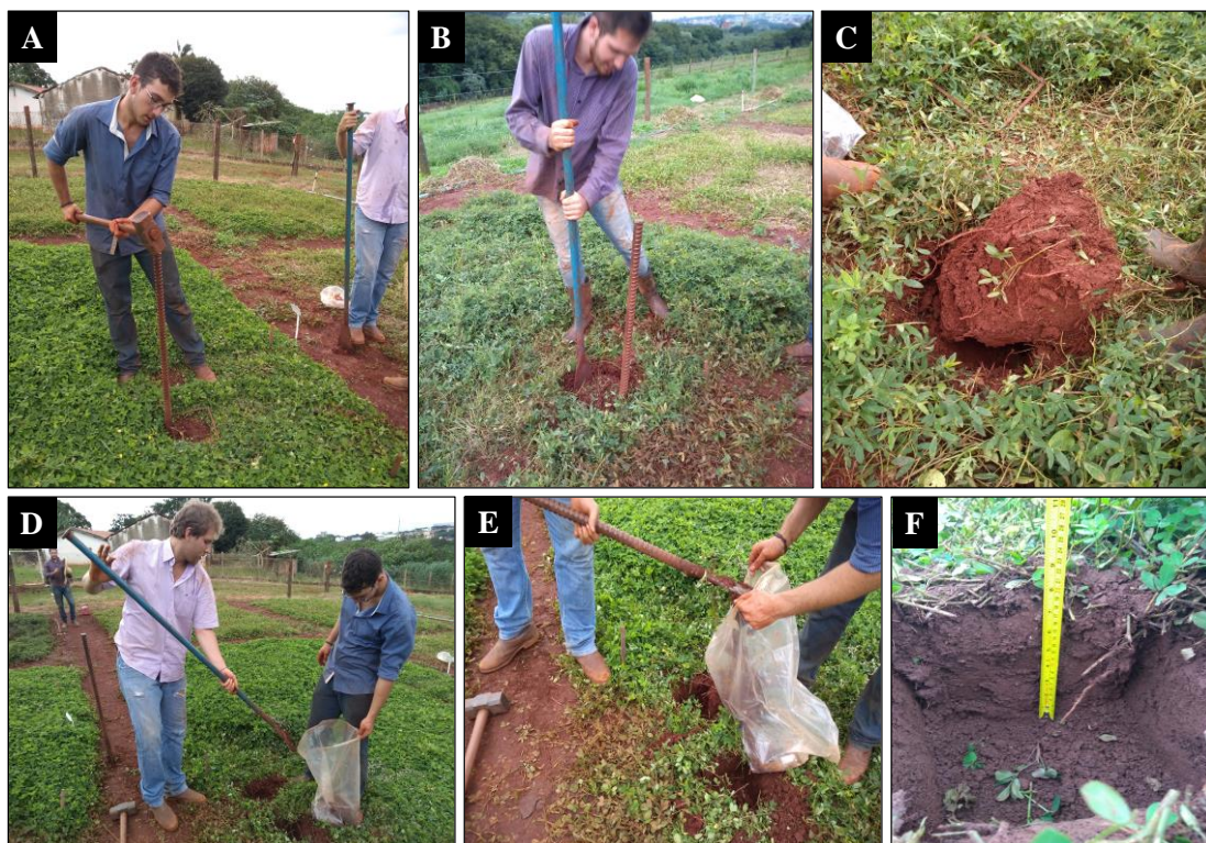
Figura 6. Coleta do sistema radicular de AG e AP. Corte de solo (6A - B); remoção do solo (6C); armazenamento da amostra em saco plástico (6D - E); verificação das dimensões do local de coleta da amostra (6F).
